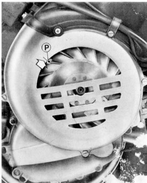
Fig. a destra: piolo "P" e tacca punzonata sul coperchio chiocciola per il controllo della fasatura.
